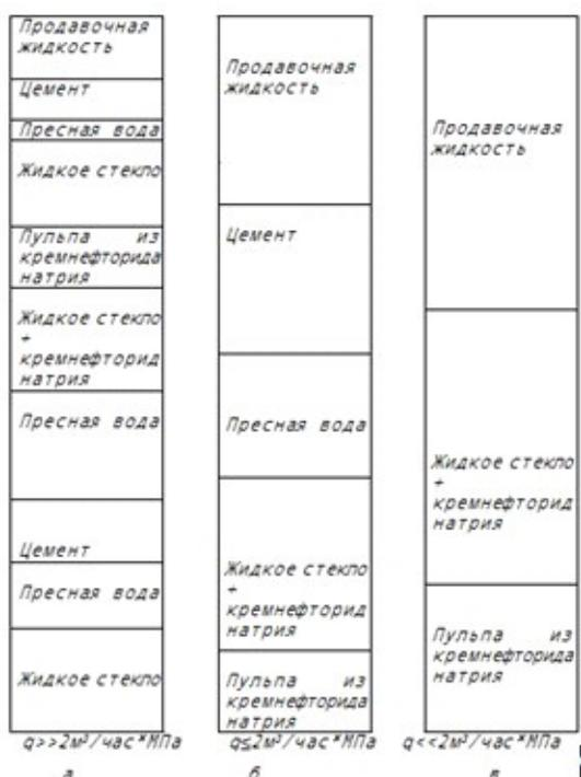
Рисунок 2.12 Последовательность закачивания по насосно-компрессорным трубам рабочих жидкостей в зону нарушения в зависимости от приемистости
